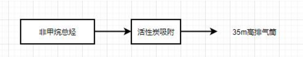
图4.2DA002和DA003非甲烷总烃治理工艺流程图
